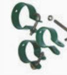
Die Schellen werden am Pfosten mit passendem Durchmesser montiert und dienen der Montage des Geflechtspannstabes und der Drahtspanner. Sie sind in verzinkt und pulverbeschichtet Grün, Anthrazit und Schwarz erhältlich.
